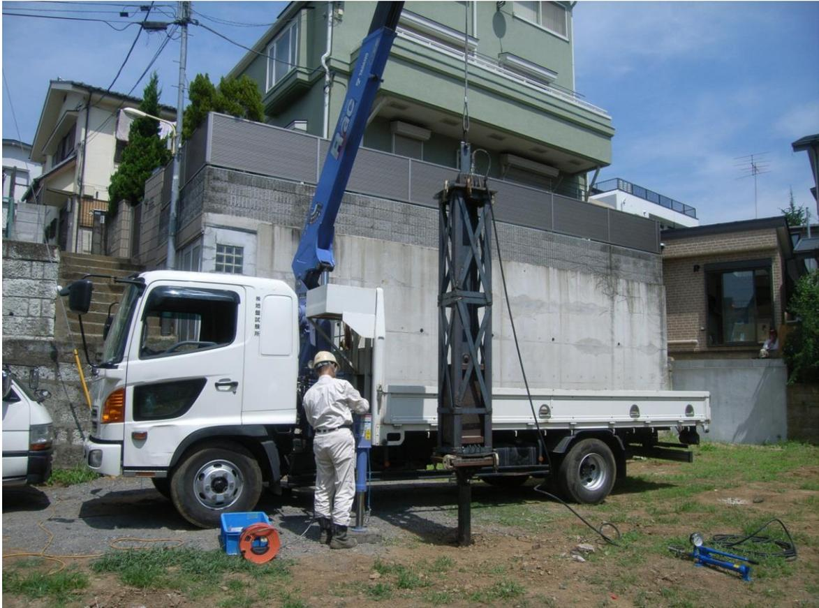
写真-1 0.4t 急速載荷試験装置設置例
