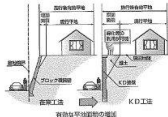
【図2】 擁壁と上物を一体化させるKD工法 高橋嘉洋・カスカデザイン
